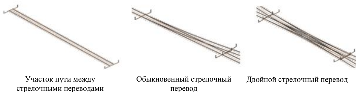
Рис. 1. Элементы составной модели железнодорожного пути
