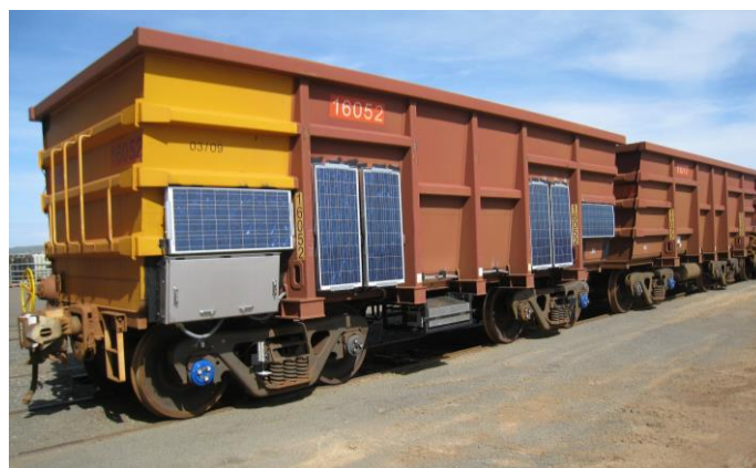
Рис. 3. Измерительный вагон для перевозки железной руды
