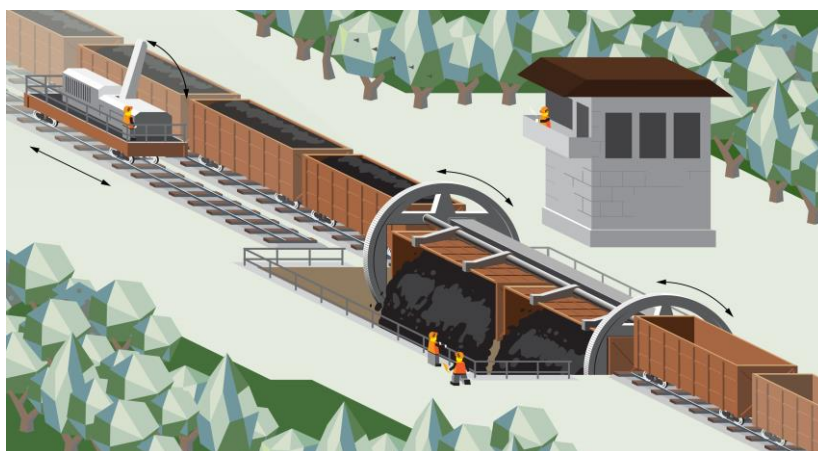
Рис. 1. Пункт разгрузки грузового состава, оборудованный стационарным роторным вагоноопрокидывателем и позиционером
