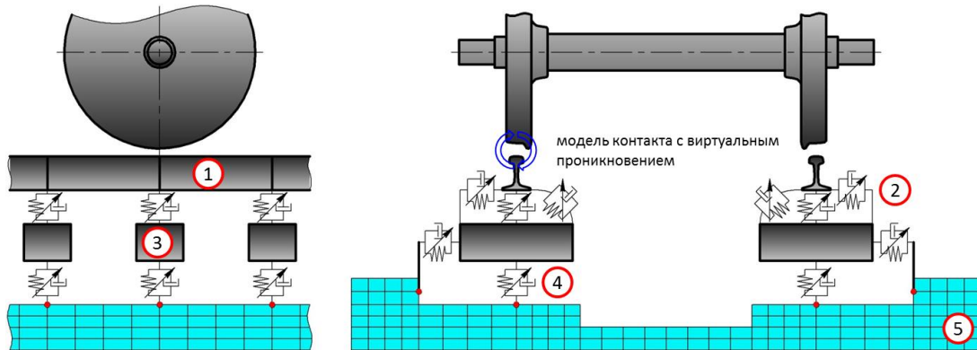
Рис. 1. Модель пути с твердыми полушпалами 1 – рельс, 2 – крепление, 3 – полушпала, 4 – подшпальная прокладка, 5 – жесткая база / упругое основание
