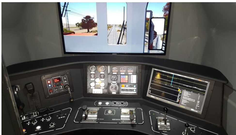
Рис. 1. Тренажер машиниста поезда, созданный с помощью ПК УМ
