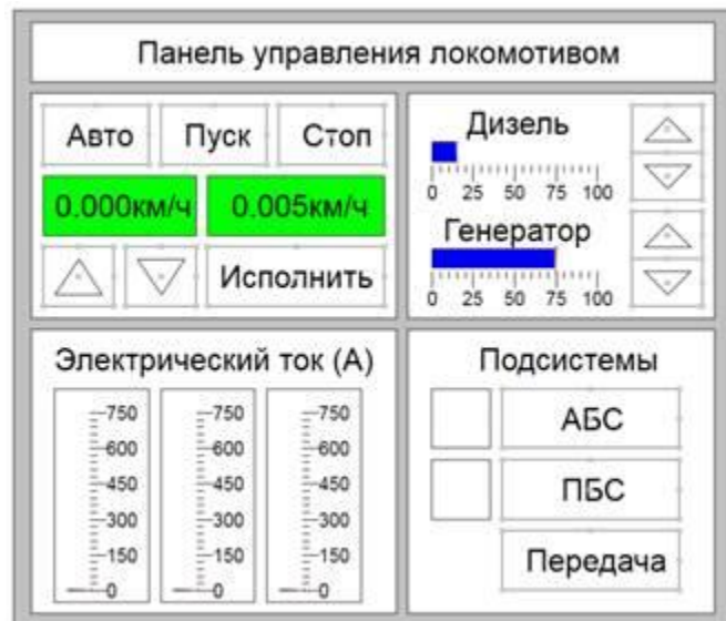
Рис. 2. Панель управления, реализованная с помощью инструментов среды SimInTech
